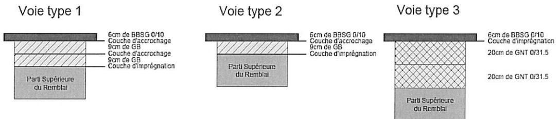
Type de structure de réfection des tranchées sous trottoir et stationnement non contigu à la chaussée
